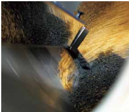
湿らせた籾と鉄粉などを機械を使って混ぜていく。
