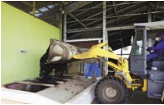
ちからくんたい肥の原料をホッパーに入れる作業です。
